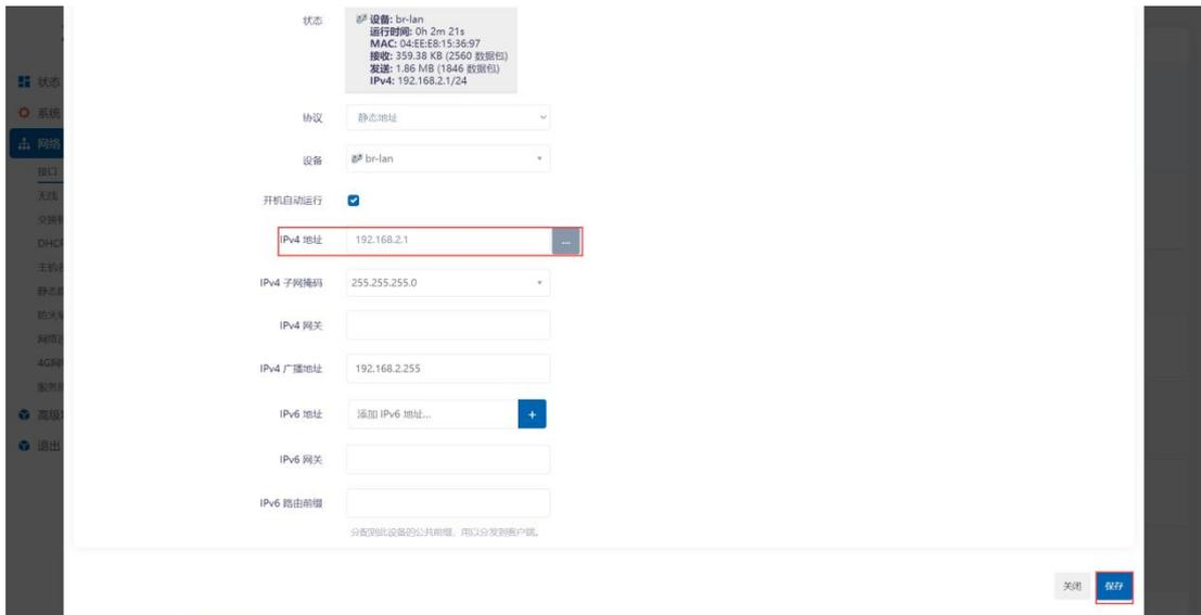
Figure 30 Save LAN parameters
